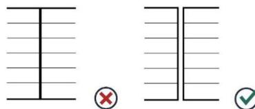
Recomendamos dejar una pequeña separación entre los paneles para mantenerlos alineados. Tengan una orientación horizontal o vertical deberán tener una separación entre 20 – 50 mm.
